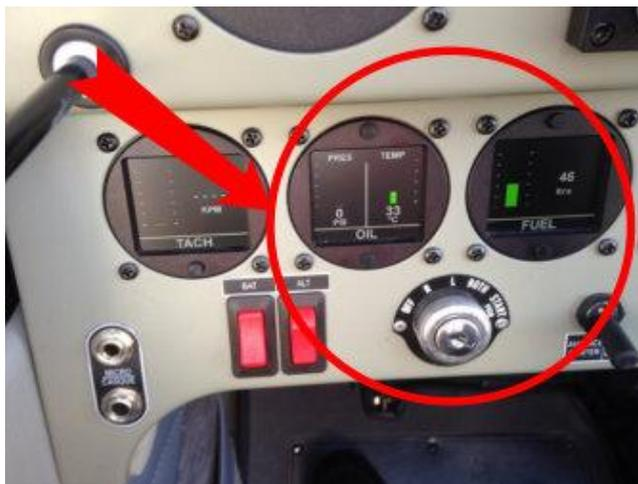
**COMMANDE DE RECHAUFFAGE CARBURATEUR** : **ATTENTION DE NE PAS LA CONFONDRE AVEC LA COMMANDE DE MIXTURE.**
