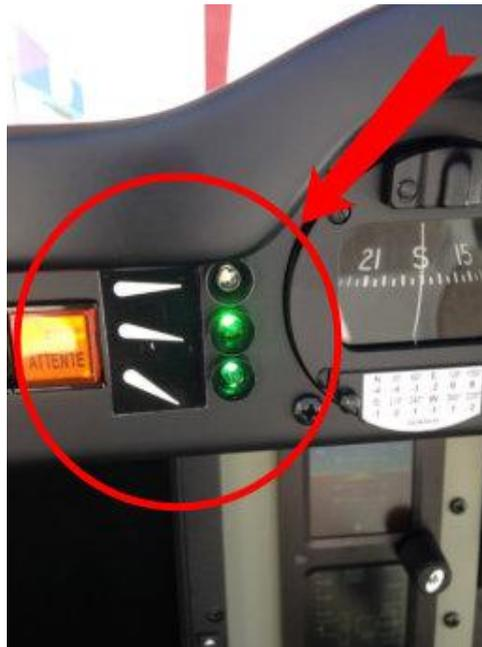
COMMANDE ELECTRIQUE DU TRIM DE PROFONDEUR actionné par interrupteurs sur le manche (plus de roulette manuelle), avec indicateur de position par leds.
